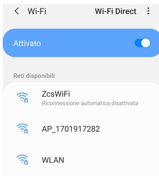
Figura 54 – Disattivazione della riconnessione automatica ad una rete
